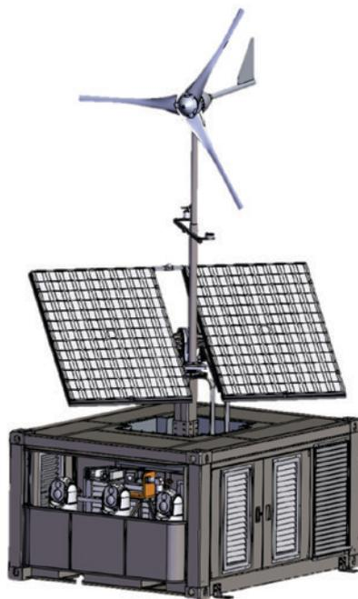
全景一体化成像装置内含全景拼接夜视枪机、全景联动夜视布控球、电池组、太阳能发电模组、风力发电模组、视频拼接服务器、视频实时算法分析服务器、平台数据请求服务器、视频与现场数据融合服务器、视频与定位导航数据标志点标定融合服务器，盖系统的组合使装置具备以下功能：
